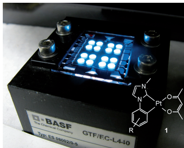
Abbildung 1. Testdioden basierend auf einer neuen Emittierklasse: cyclometallierte Pt-NHC-Komplexe. [5]
